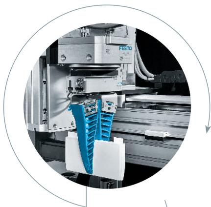
自适应抓手手指 **DHAS** 可自适应工件形状。这意味着, 即使工件的外形有弯曲弧度, 如软包电池, 也能被牢固抓取, 而不被损坏。
